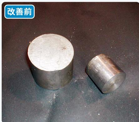
SUS304 は、刃物の消耗が激しいため、加工時間も通常のステンレスの倍かかってしまいます。
