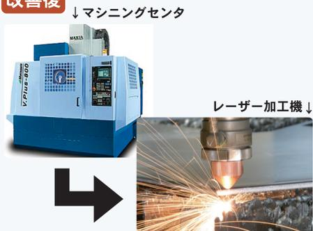
要求精度が 100 $\mu$ m 台であれば、レーザーでも問題無く加工が可能になります。したがって加工時間の削減となり、コストダウンにつながります。
